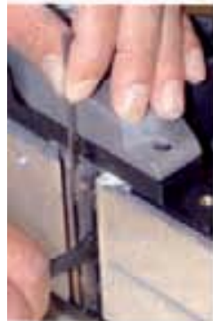
Die Wendemesser sind leicht zu wechseln und sind durch die Führungen auch nicht falsch einzubauen
